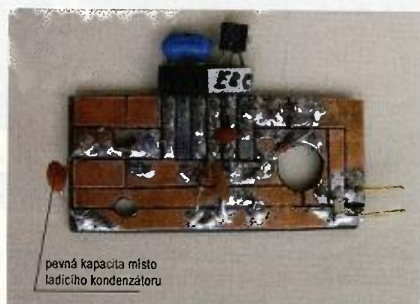
Obr. 7. Praktická realizace oscilátoru z obr. 6
