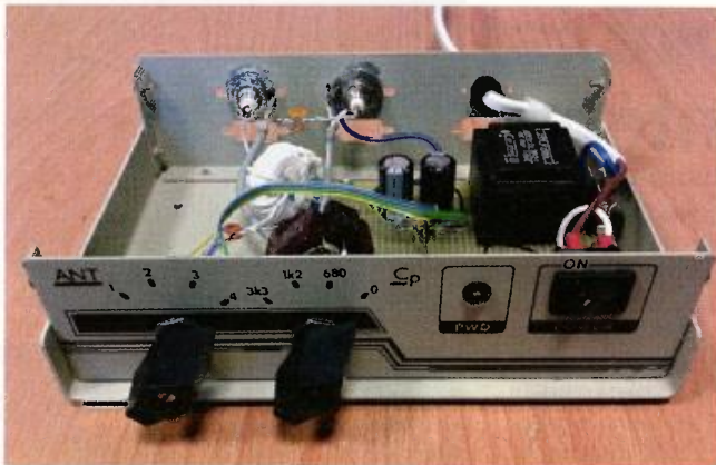
Obr. 5. Vnitřní jednotka přepínače antén (vlevo)
