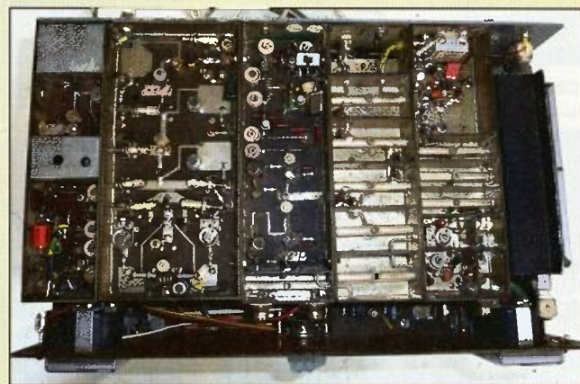
Obr. 23. Pohled shora na soustavu transvertorů pro pásma 1296 a 2320 MHz (dole)
