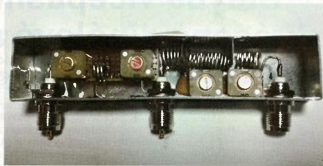
Obr. 8. Diplexer ve stíněné krabici
