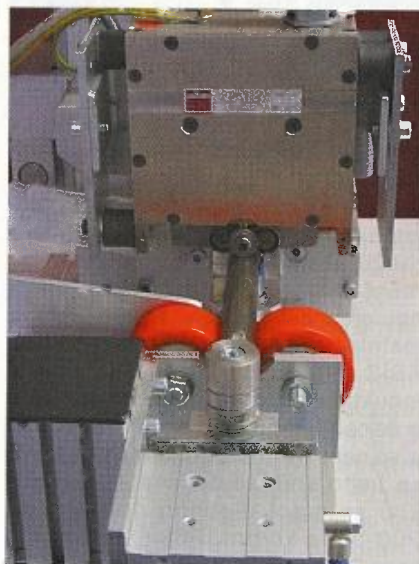
Obr. 2. Indikace svaru trubky - snímač NS12
