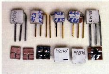
Obr. 2. Destičky s připájenými SMD tranzistory
