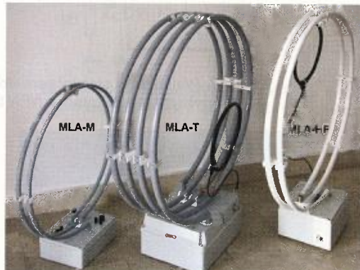
Obr. 18. Zleva: MLA-M (multiband, 10 W), MLA-T (1,8 a 3,5 MHz, 100 W) a MLA-HF (atypická, speciální zakázka pro neamatérské účely, 5 – 7 MHz, 100 W)
