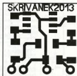
Obr. 4. Deska s plošnými spoji INV1 (2 : 1)
