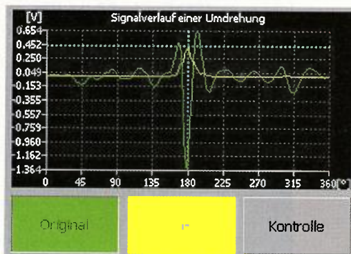
Obr. 3. Průběh jedné otáčky indikace svaru - na monitoru jednotky SND40
